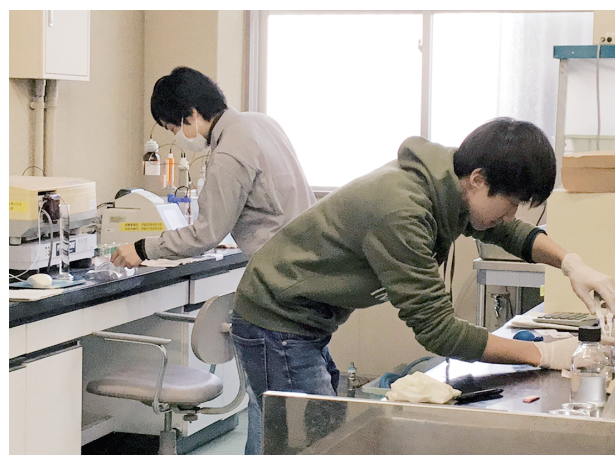
硬化コンクリート中に含まれる 塩化物イオンの試験 （TIF Net※を通じた鳥取大学との連携）
