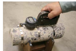
コンクリートコアの膨張量測定
